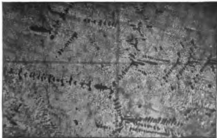
Fig. 18. Alloy of 80 per cent Copper, 20 per cent Silver.
